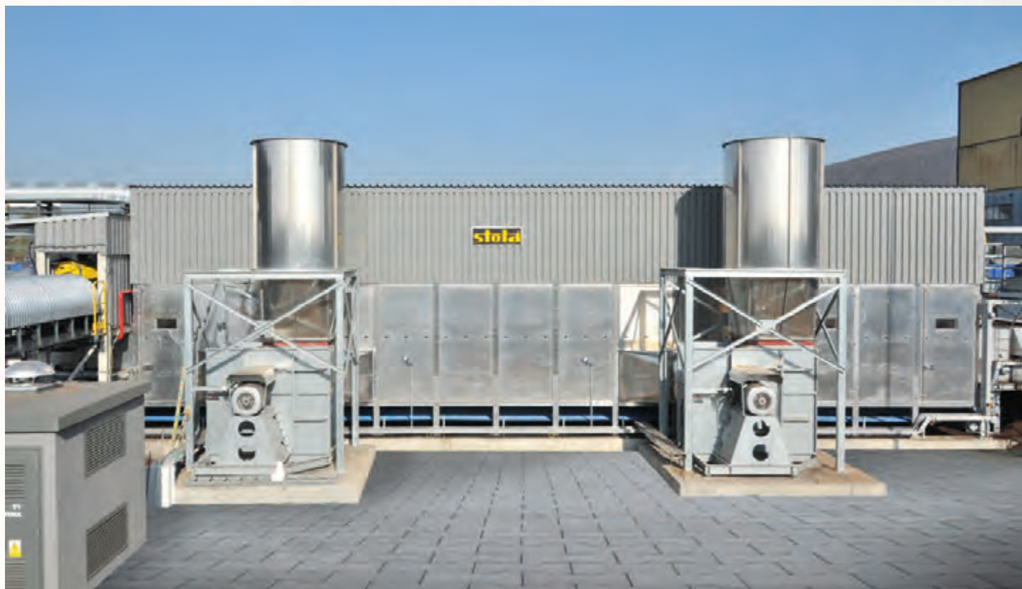
项目地：Polski Koks S.A., 波兰 | 型号：BT 1/6200-21-K | 安装年份：2013 干燥物料：煤球 | 出料能力：约10.0吨/小时 | 降水区间：28% - 8%湿度
