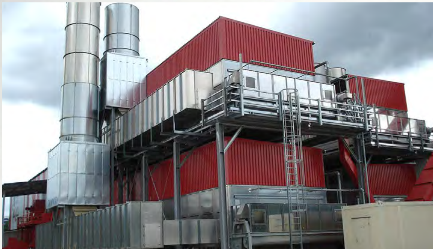
项目地：JRS Holzenergie, 德国 | 型号：4x BT 1/6200-22.5 | 安装年份：2007 干燥物料：木屑 | 出料能力：约29.0吨/小时 | 降水区间：50% - 10%湿度
