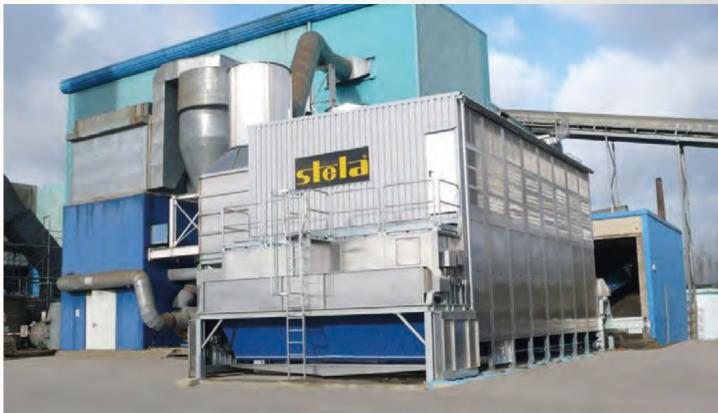
项目地：Thermopell, 德国 | 型号：BT 1/6200-12 | 安装年份：2015 干燥物料：木片 | 出料能力：约5.6吨/小时 | 降水区间：50% -20%湿度
