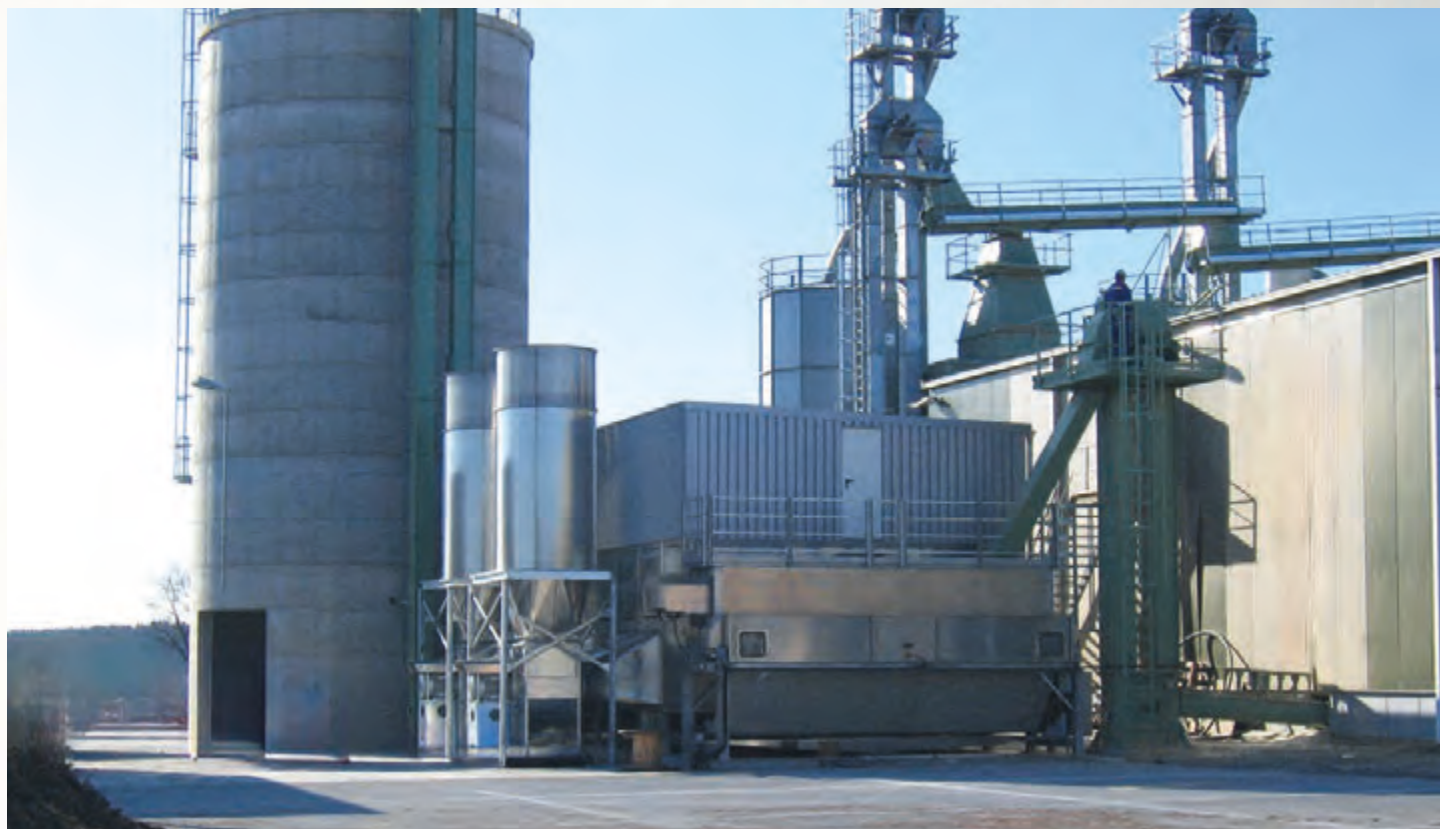
项目地：HVT GmbH, 德国 | 型号：BT 1/6200-10.5 | 安装年份：2007 干燥物料：木屑 | 出料能力：约3.6吨/小时 | 降水区间：50% - 10% 湿度
