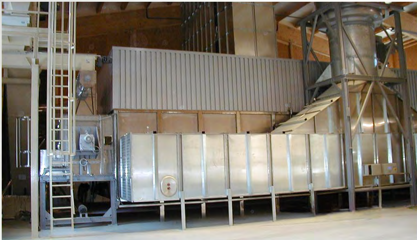
项目地：Firestixx SalzburgPellet, 奥地利 | 型号：BT 1/6200-16.5 | 安装年份：2004 干燥物料：木屑 | 出料能力：约5.0吨/小时 | 降水区间：50% - 10%湿度
