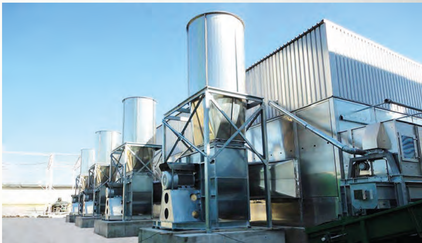
项目地：Hekotek, 爱沙尼亚 | 型号：BT 1/6200-34.5 | 安装年份：2011 干燥物料：木屑 | 出料能力：约12.0吨/小时 | 降水区间：53% - 11%湿度
