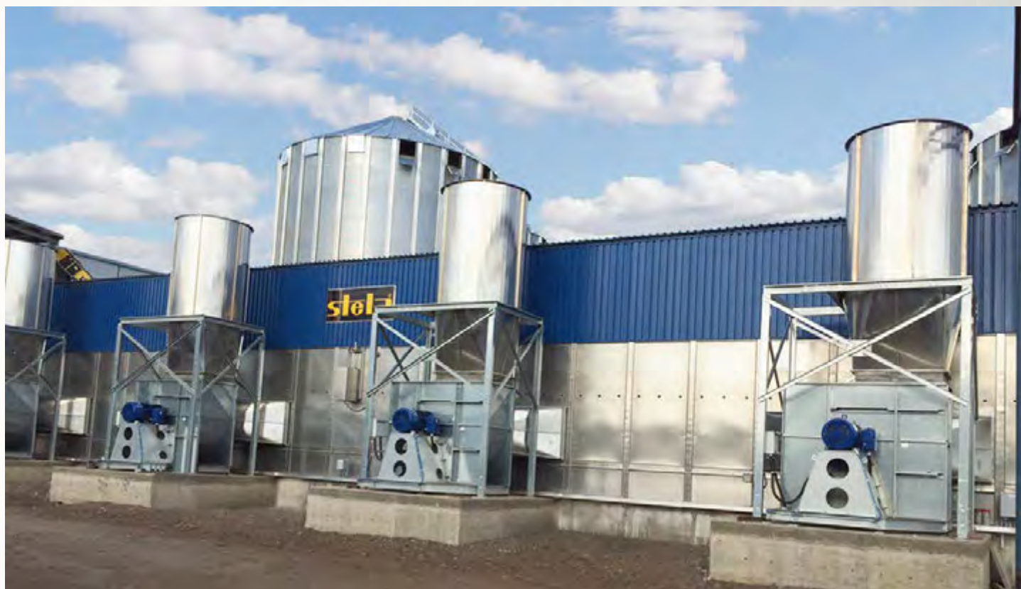
项目地：Del-Tech / Canfor 加拿大 | 型号：BT 1/6200-34.5 | 安装年份：2015 干燥物料：木屑、刨花混料 | 出料能力：约15.1吨/小时 | 降水区间：45% - 8%湿度
