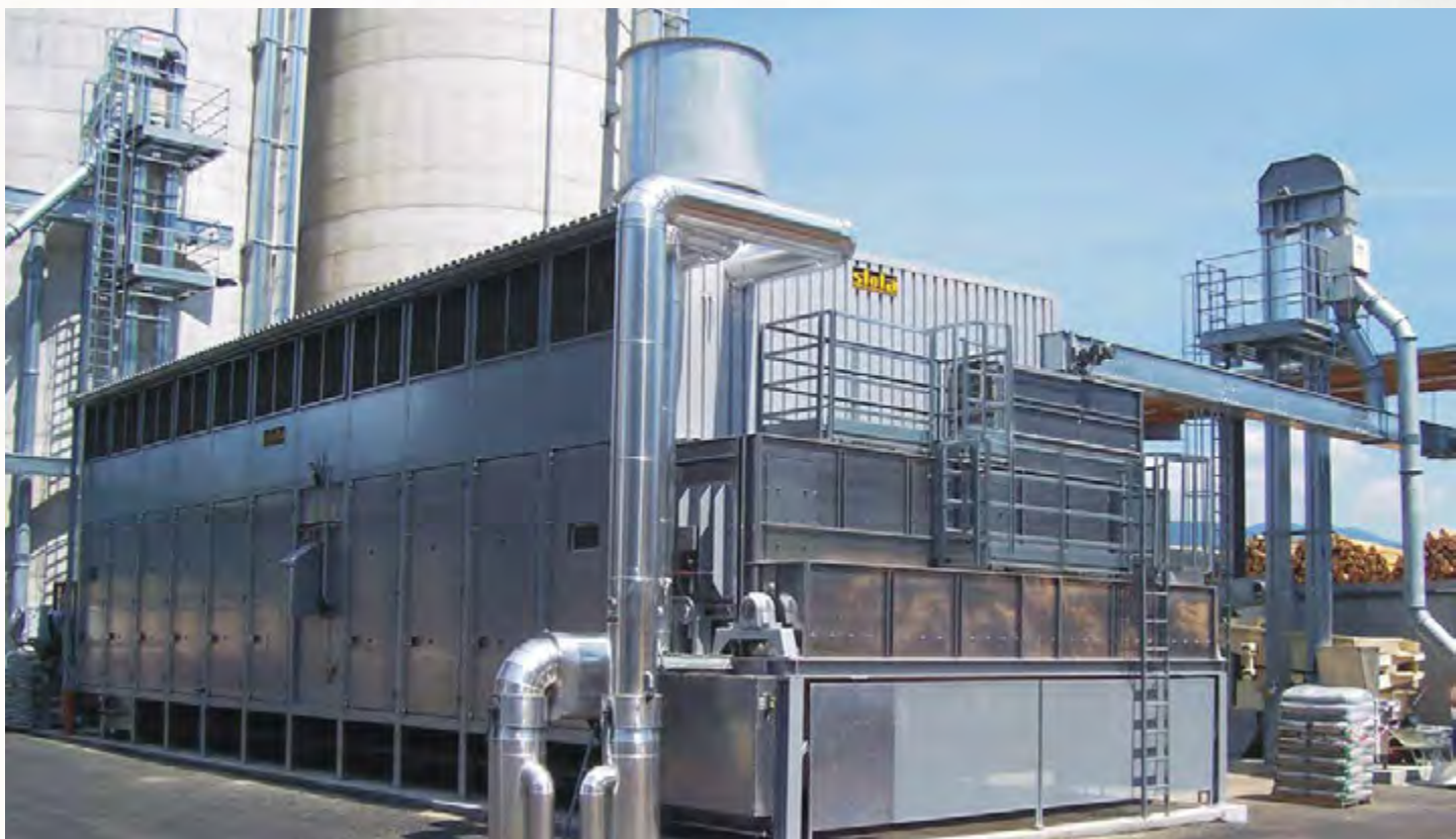
项目地：Mayr-Melnhof, 奥地利 | 型号：BT 1/6200-16.5 | 安装年份：2004 干燥物料：木屑 | 出料能力：约6.7吨/小时 | 降水区间：45% - 10%湿度
