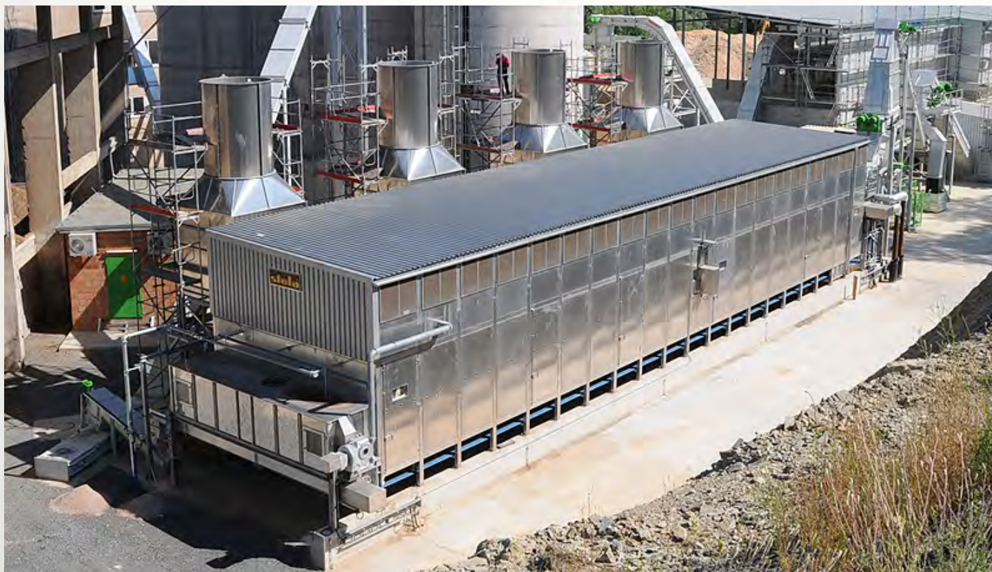
项目地： ECB GmbH, 德国 | 型号： BT 1/6200-30 | 安装年份： 2009 干燥物料： 木屑 | 出料能力： 约8.0吨/小时 | 降水区间： 50% - 9%湿度
