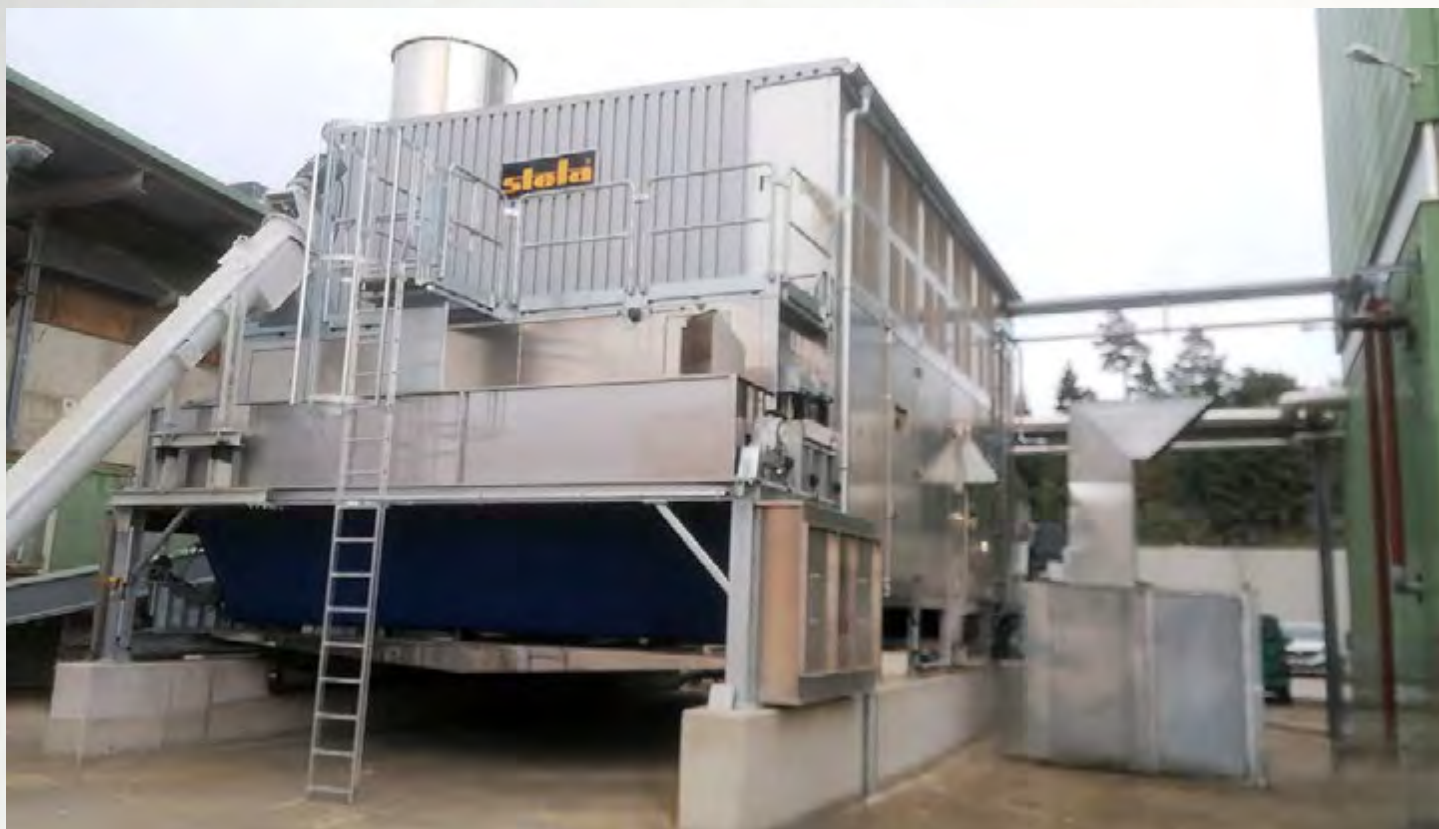
项目地：Hasslach, 奥地利 | 型号：BT 1/6200-9 | 安装年份：2022 干燥物料：木屑 | 出料能力：约3.0吨/小时 | 降水区间：50% - 10%湿度
