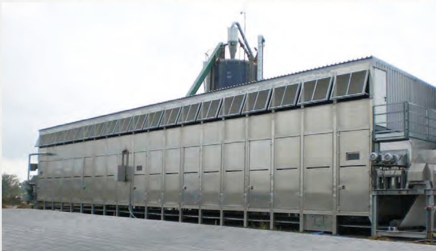
项目地：Tartak - „Olczyk”, 波兰 | 型号：BT 1/6200-30 | 安装年份：2008 干燥物料：木屑 | 出料能力：约8.0吨/小时 | 降水区间：50% - 10%湿度
