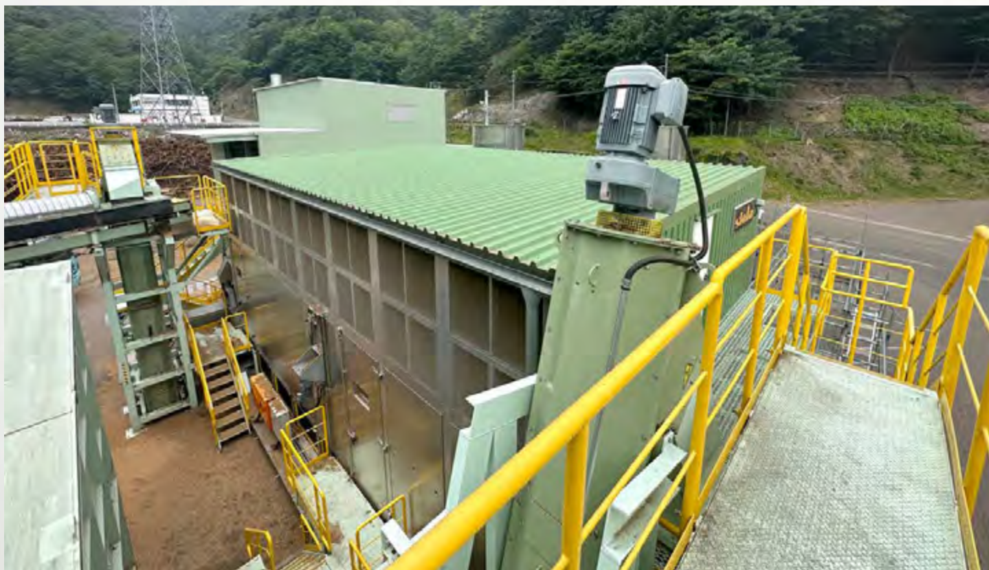
项目地：日本制铁和住友金属公司, 日本 | 型号：BT 1/6200-12 | 安装年份：2019 干燥物料：木片 | 出料能力：约5.0吨/小时 | 降水区间：50% - 25%湿度
