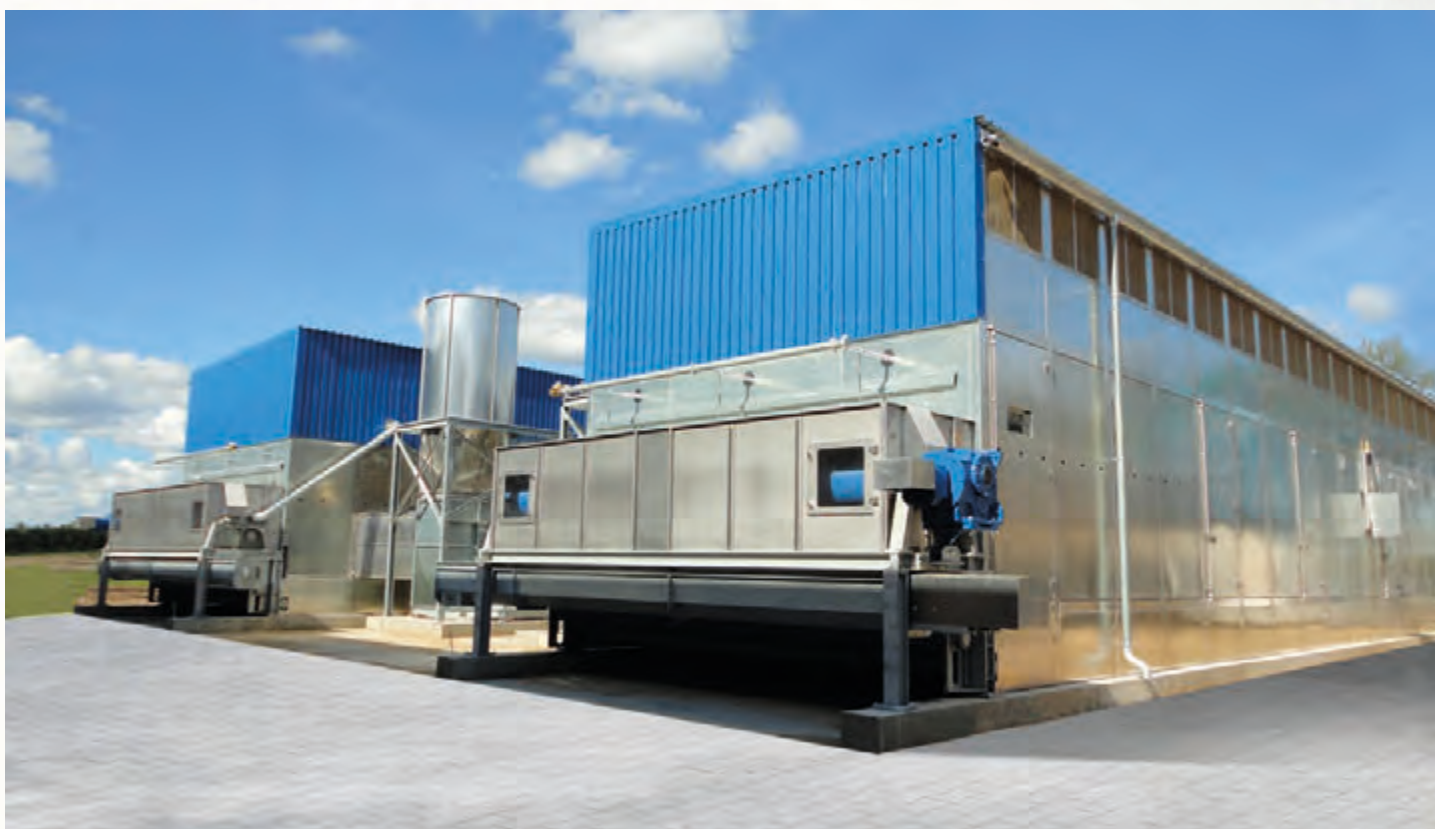
项目地：Graanul Invest, 爱沙尼亚 | 型号：2x BT 1/6200-30 | 安装年份：2011 干燥物料：木屑 | 出料能力：约2x 8.5吨/小时 | 降水区间：50% - 10%湿度
