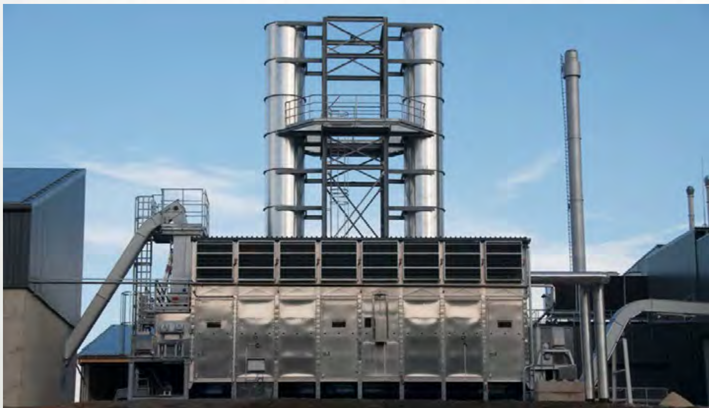
项目地：AGO AG, 德国 | 型号：BT 1/6200-12 | 安装年份：2012 干燥物料：木屑 | 出料能力：约3.5吨/小时 | 降水区间：50% - 10%湿度
