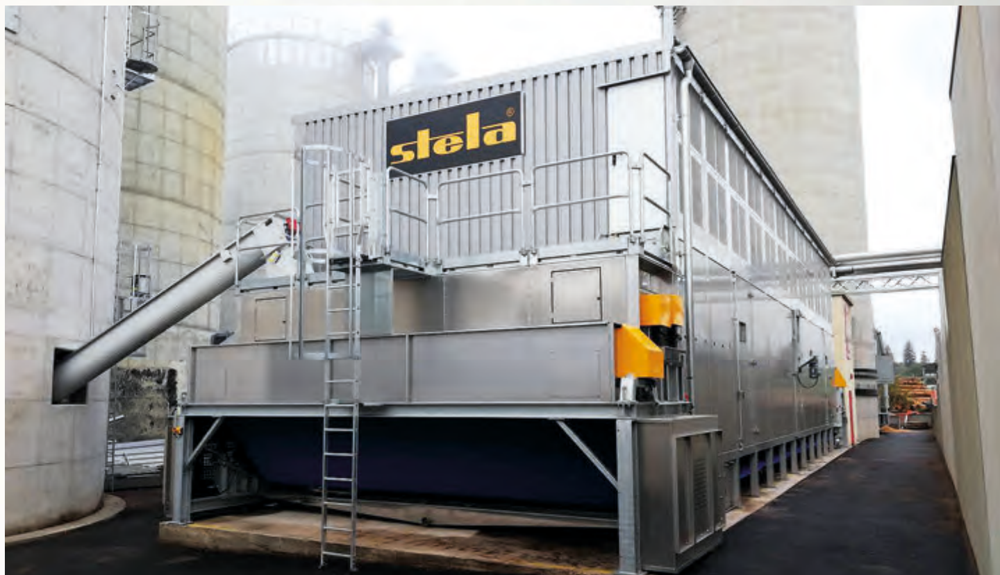
项目地：GDM Pellets, 法国 | 型号：BT 1/6200-18 | 安装年份：2019 干燥物料：木屑 | 出料能力：约6.0吨/小时 | 降水区间：50% - 10%湿度
