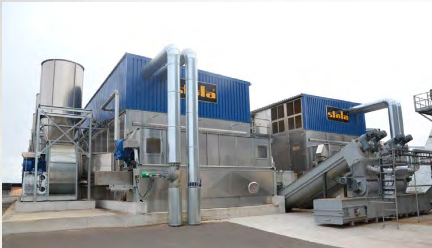
项目地：AS Graanul Invest, 爱沙尼亚 | 型号：2x BT 1/6200-49.5 | 安装年份：2016 干燥物料：木屑 | 出料能力：约2x 14.1吨/小时 | 降水区间：50% - 10%湿度
