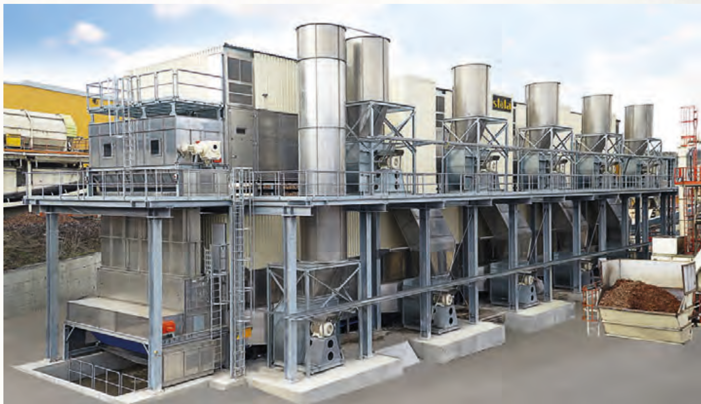
项目地：SFC Integrated, 土耳其 | 型号：BTU 2/6200-45 | 安装年份：2015 干燥物料：OSB定向刨花板 | 出料能力：约25.0吨/小时 | 降水区间：50% -2%湿度
