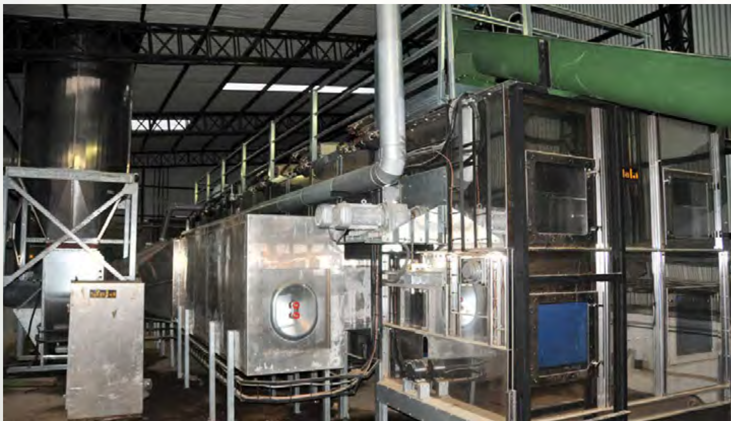
项目地：Ponlar Sa, 乌拉圭 | 型号：BT 1/2700-12 | 安装年份：2012 干燥物料：木屑 | 出料能力：约1.8吨/小时 | 降水区间：55% - 15%湿度
