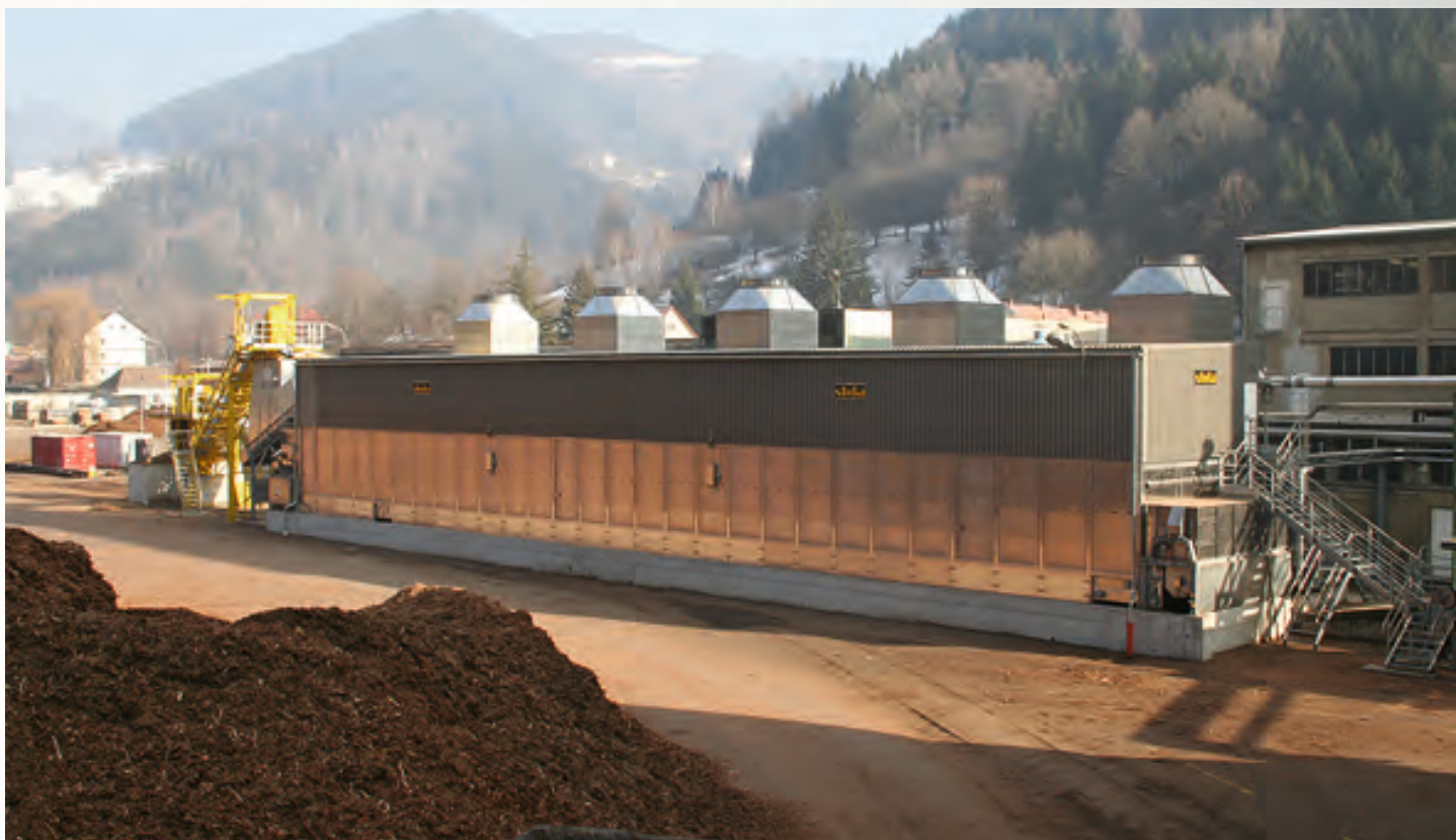
项目地：Mondi Frantschach GmbH, 奥地利 | 型号：BT 1/6200-42 | 安装年份：2010 干燥物料：树皮 | 出料能力：约26.4吨/小时 | 降水区间：53% - 37%湿度
