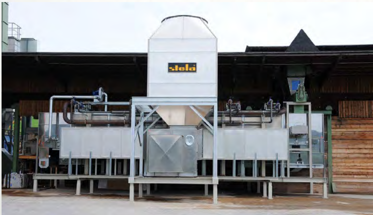
项目地：Baust Holzbetriebe, 德国 | 型号：BT 1/2700-11 | 安装年份：2010 干燥物料：木屑 | 出料能力：约1.6吨/小时 | 降水区间：50% - 10%湿度
