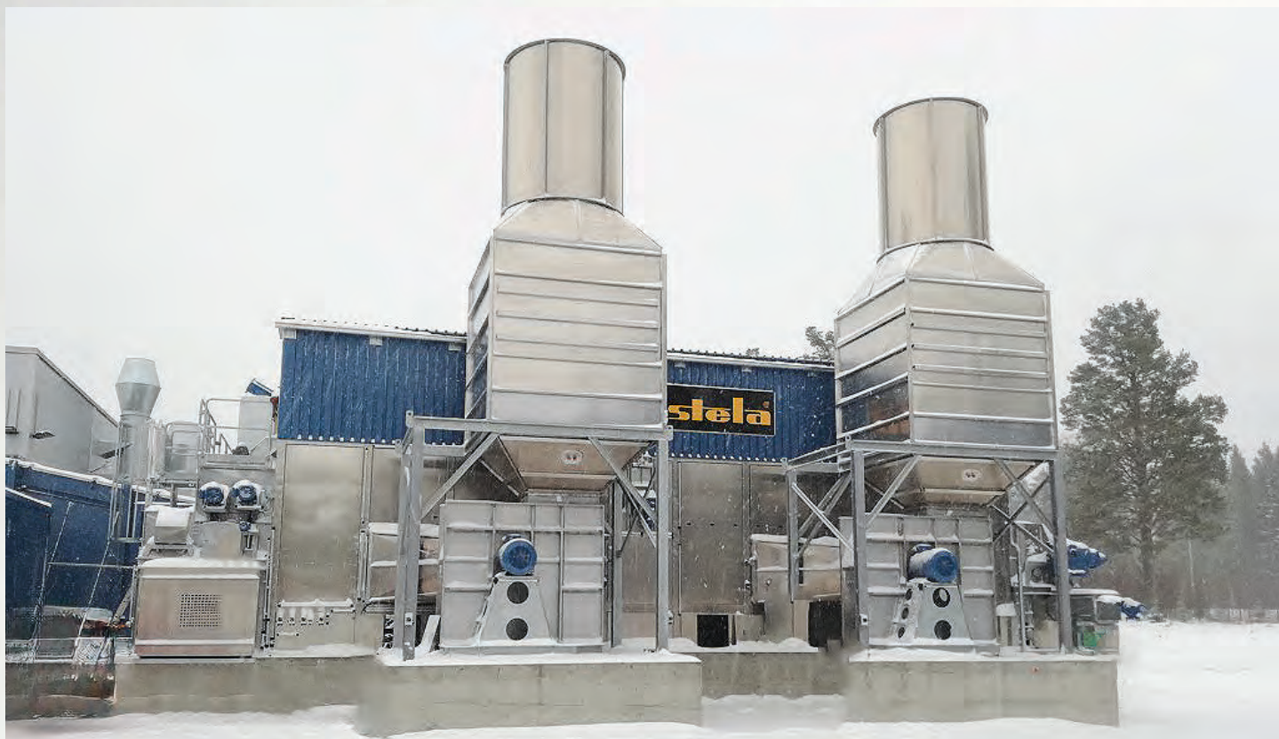
项目地：Bioendev AB, 瑞典 | 型号：BT 1/6200-15 | 安装年份：2017 干燥物料：木屑、木片 | 出料能力：约3.4吨/小时 | 降水区间：55% - 3%湿度
