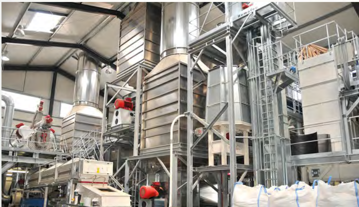
项目地：Prinz-Eugen-Energiepark GmbH, 德国 | 第1台：BT 1/6200-15 | 第2台：BT 1/6200-9 | 安装年份：2012 | 干燥物料：木屑 第1台出料能力：约4.4吨/小时 | 降水区间：50% - 10%湿度 | 第2台出料能力：2.5吨/小时 | 降水区间：50% - 10%湿度
