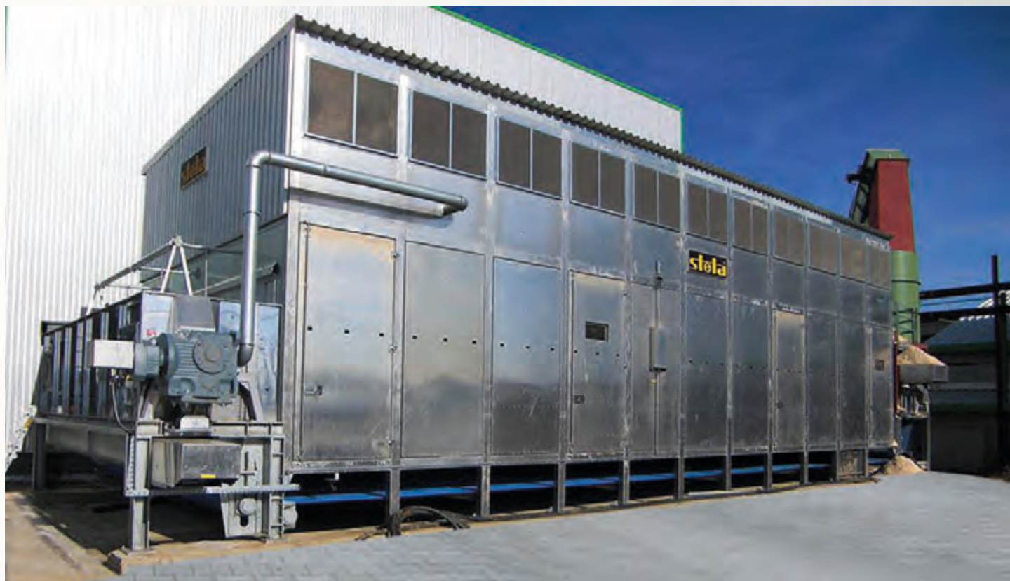
项目地：Ameco, 罗马尼亚 | 型号：BT 1/6200-16.5 | 安装年份：2009 干燥物料：木屑 | 出料能力：约6.0吨/小时 | 降水区间：50% - 10%湿度
