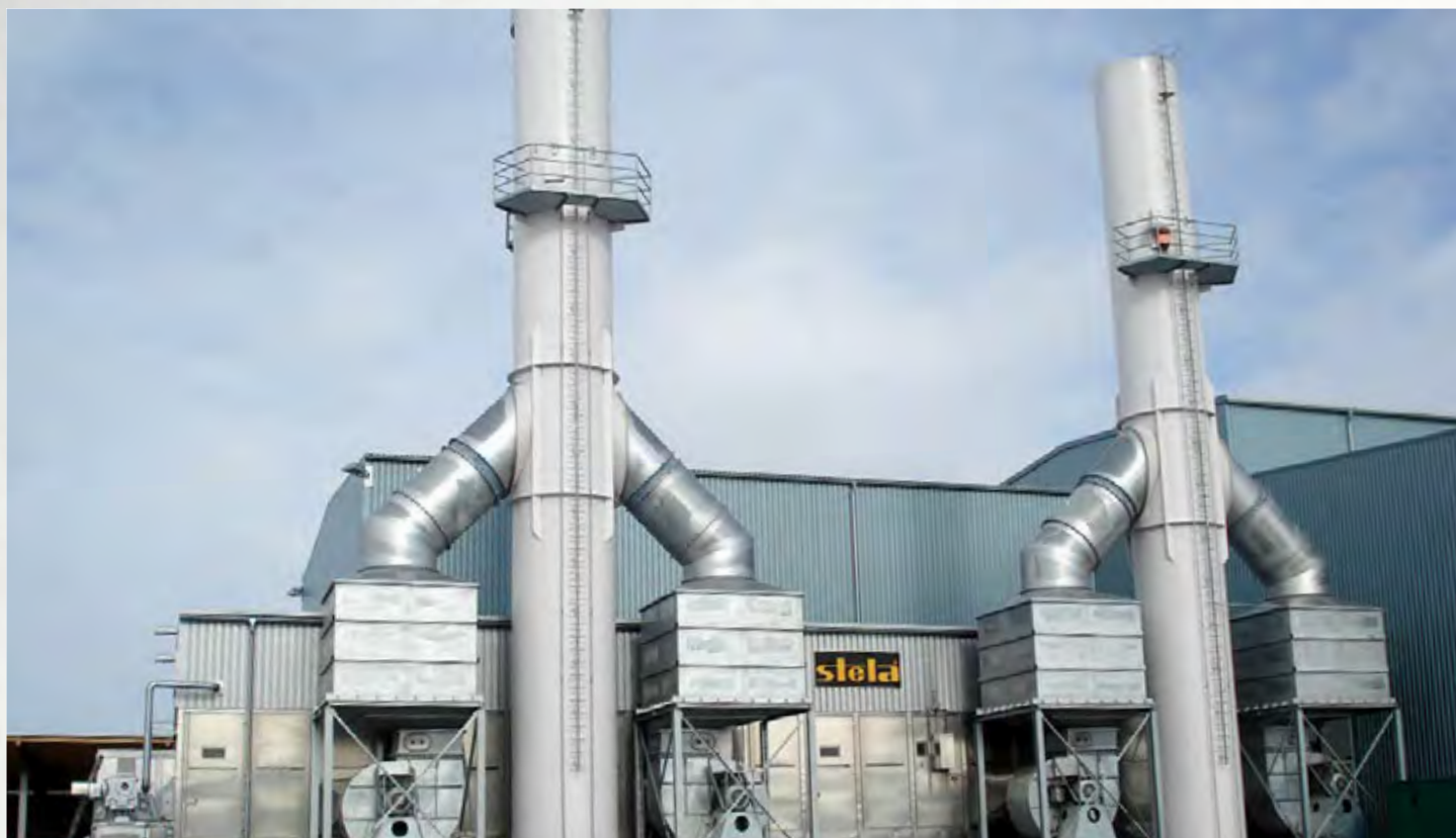
项目地：Brennpunkt Energie GmbH, 德国 | 型号：BT 1/6200-33 | 安装年份：2007/2008 干燥物料：木片、树皮、草和秸秆 | 出料能力：木片约50.0吨/小时 | 降水区间：50% - 15%湿度
