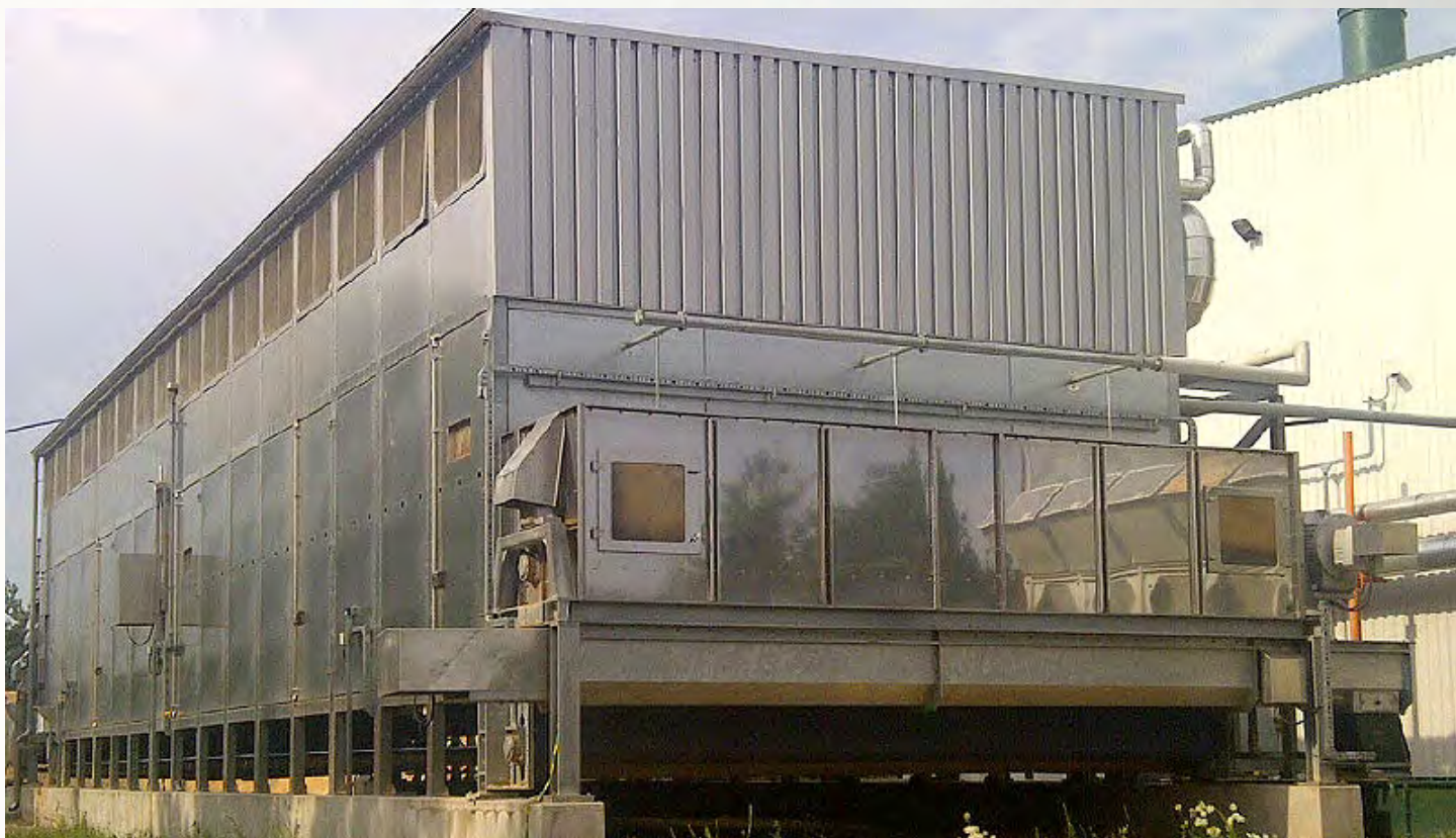
项目地：Eco Power Plant, 波兰 | 型号：BT 1/6200-24 | 安装年份：2014 干燥物料：木屑 | 出料能力：约8.0吨/小时 | 降水区间：50% -10%湿度
