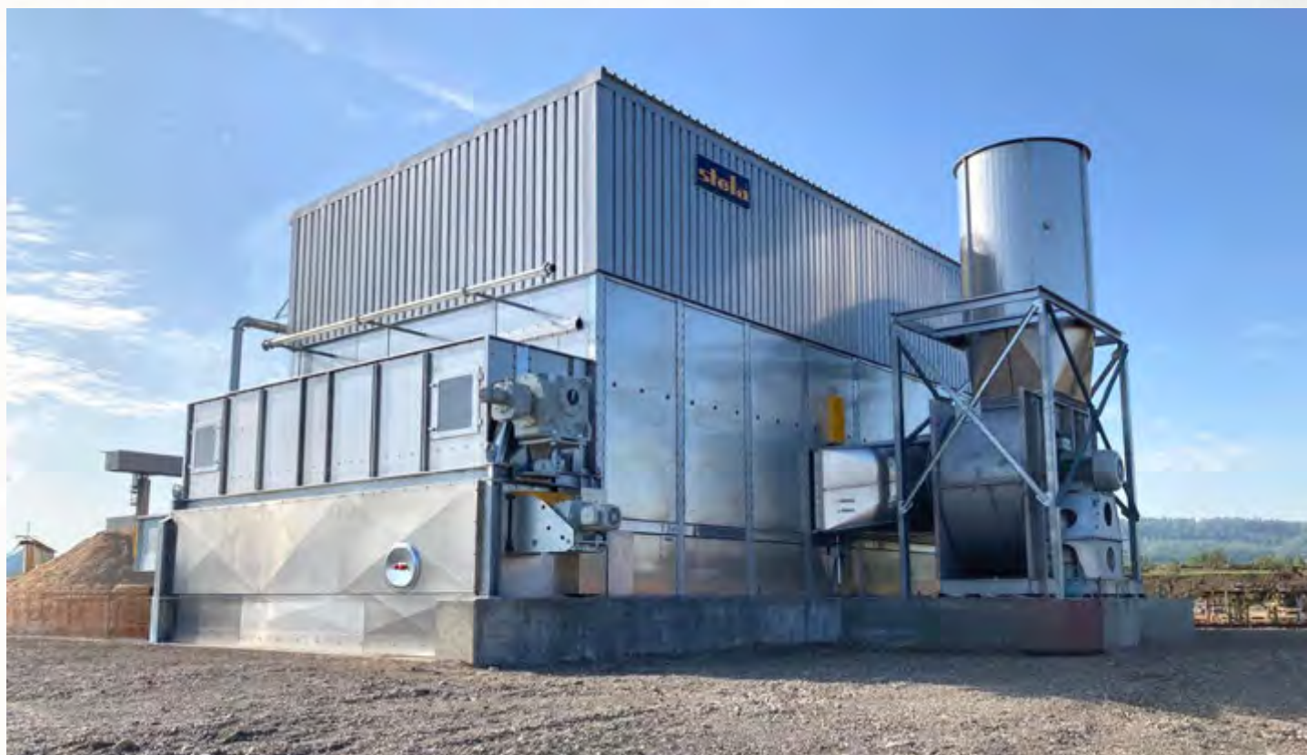
项目地：Arbios Biotech, 加拿大 | 型号：BT 1/6200-12 | 安装年份：2022 干燥物料：湿废木料 | 出料能力：约4.5吨/小时 | 降水区间：55% - 20%湿度
