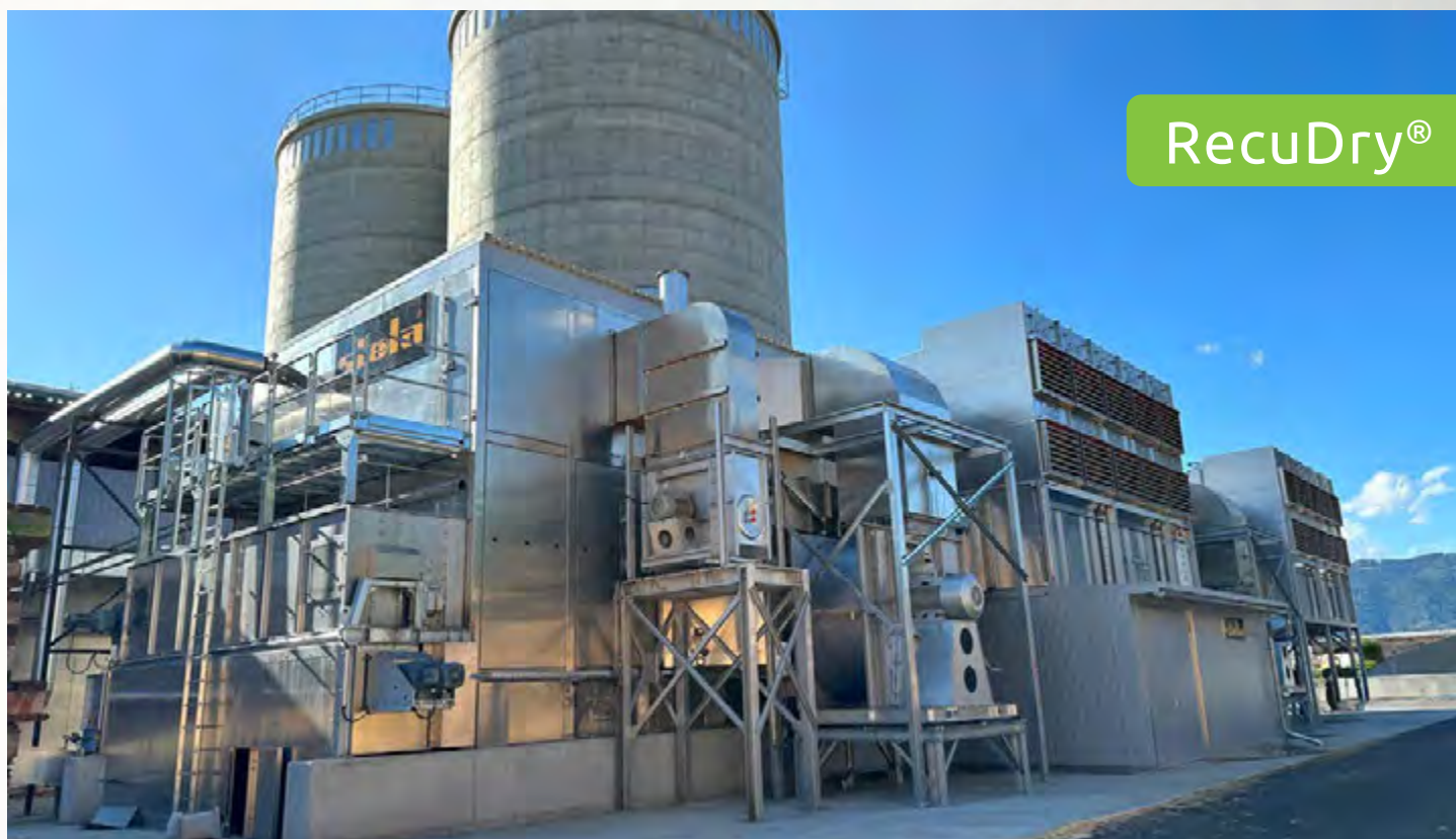
项目地：Johann Pabst Holzindustrie, 奥地利 | 型号：BTU RecuDry 1/6200-33 | 安装年份：2023 干燥物料：木屑 | 出料能力：约9.0吨/小时 | 降水区间：50% - 10%湿度
