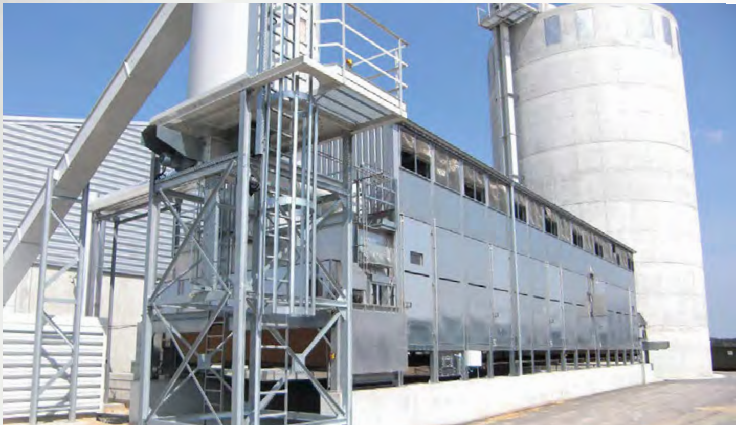
项目地：Pröbstl, 德国 | 型号：BT 1/6200-22.5 | 安装年份：2007 干燥物料：木屑 | 出料能力：约8.0吨/小时 | 降水区间：50% - 10% 湿度
