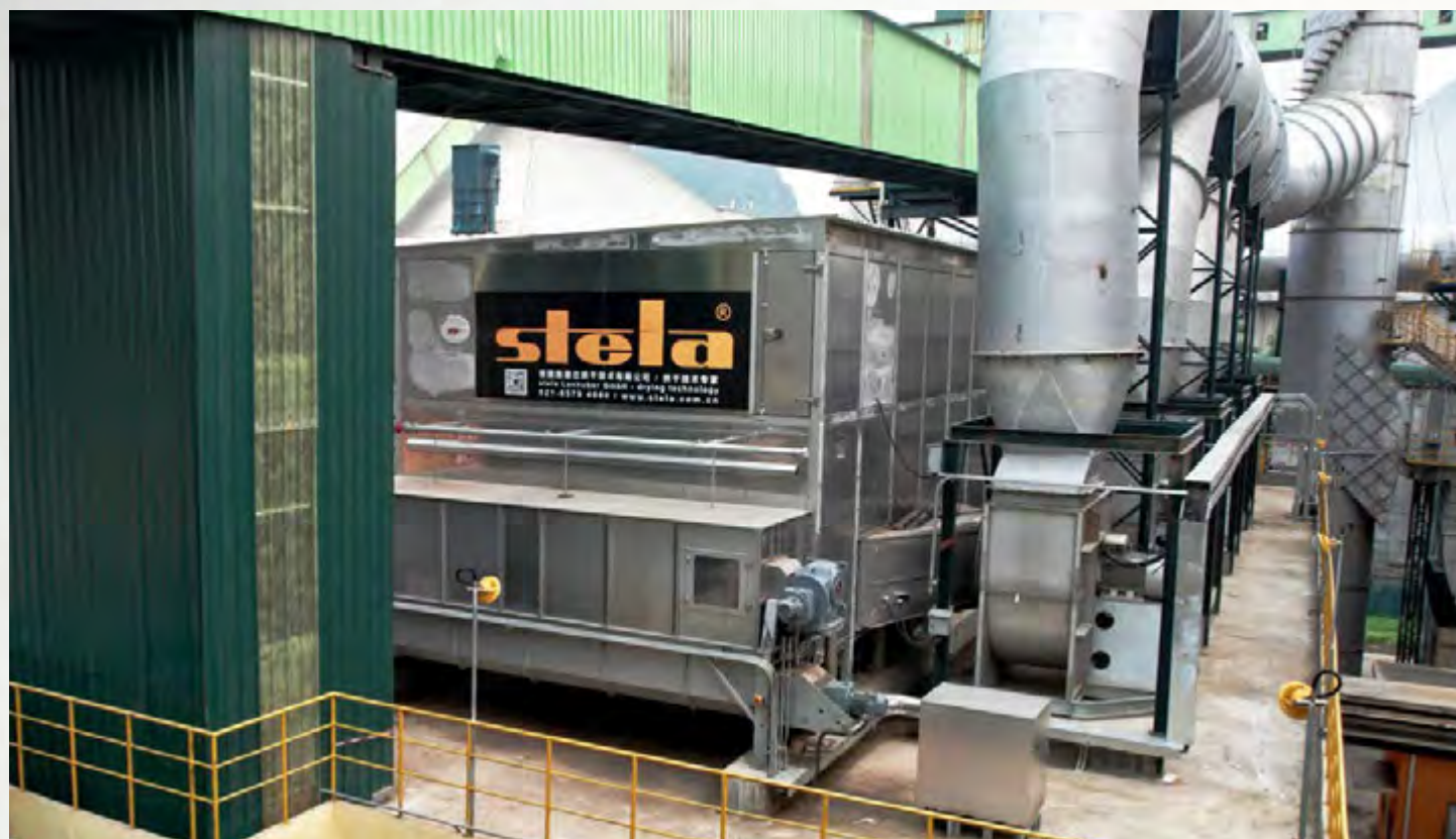
项目地：台泥贵港水泥，中国 | 型号：BT 1/6200-30 | 安装年份：2022 干燥物料：RDF垃圾燃料和树皮混料 | 出料能力：约12.4吨/小时 | 降水区间：50% - 15%湿度
