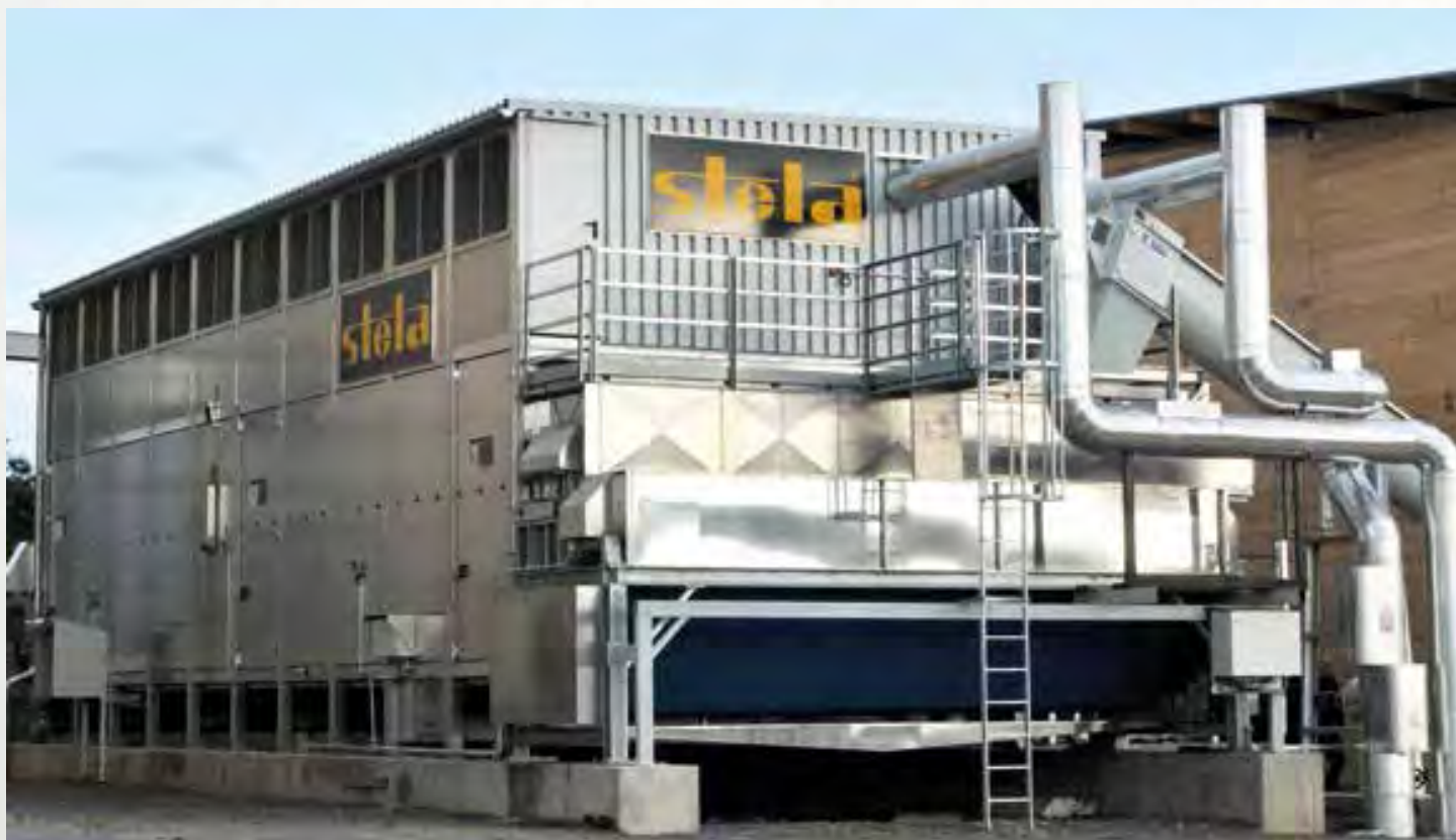
项目地：Ante Holz GmbH & Co. KG, 德国 | 型号：BT 1/6200-15 | 安装年份：2012 干燥物料：木屑 | 出料能力：约5.0吨/小时 | 降水区间：50% - 10%湿度
