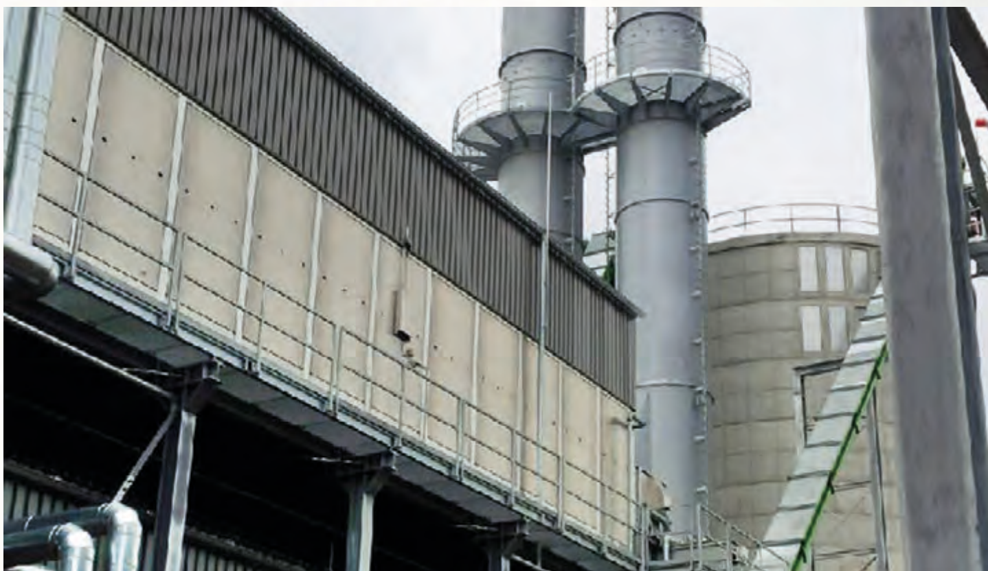
项目地：EVO Energieversorgung, 德国 | 型号：BT 1/6200-19.5 | 安装年份：2014 干燥物料：木屑 | 出料能力：约6.0吨/小时 | 降水区间：50% - 9%湿度
