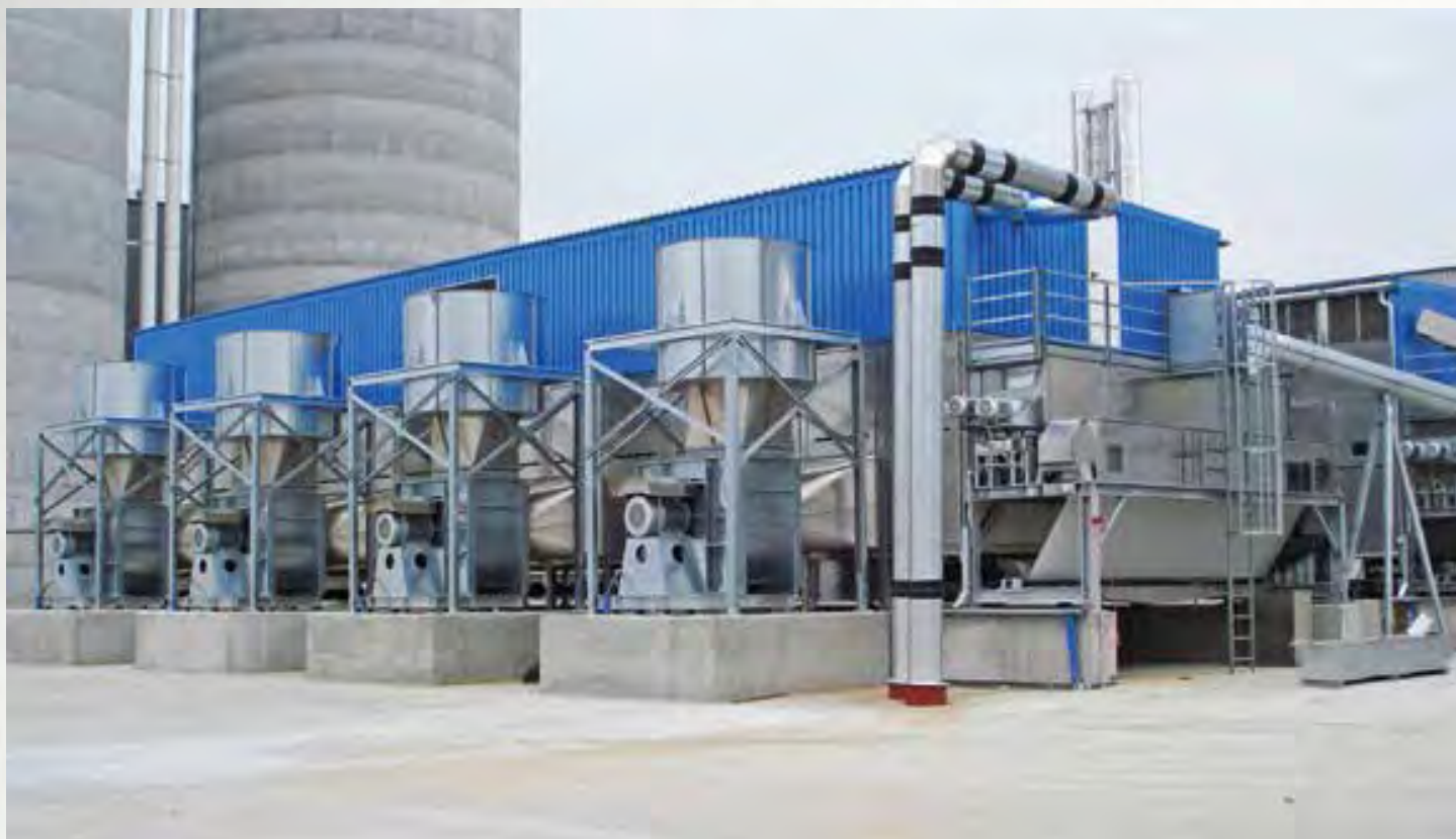
项目地：Stelmet S.A., 波兰 | 型号：BT 1/6200-24 | 安装年份：2015 干燥物料：木屑 | 出料能力：约8.0吨/小时 | 降水区间：50% - 10%湿度
