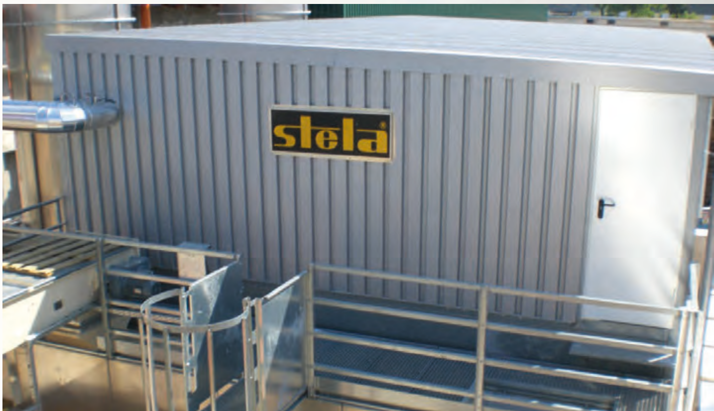
项目地：Barlinek, 乌克兰 | 型号：BT 1/6200-12 | 安装年份：2008 干燥物料：木屑 | 出料能力：约4.4吨/小时 | 降水区间：50% - 10%湿度
