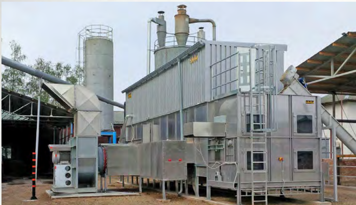
项目地：Postavsky furniture center, 白俄罗斯 | 型号：BT 1/2700-11 | 安装年份：2014 干燥物料：木屑、碎木片 | 出料能力：约1.18吨/小时 | 降水区间：55% - 10%湿度
