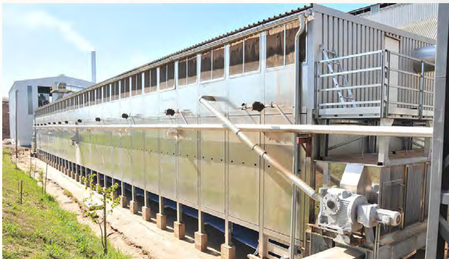
项目地：BioEner, 乌拉圭 | 型号：BT 1/6200-48 | 安装年份：2011 干燥物料：木屑、木片混料 | 出料能力：约21.0吨/小时 | 降水区间：50% - 20%湿度
