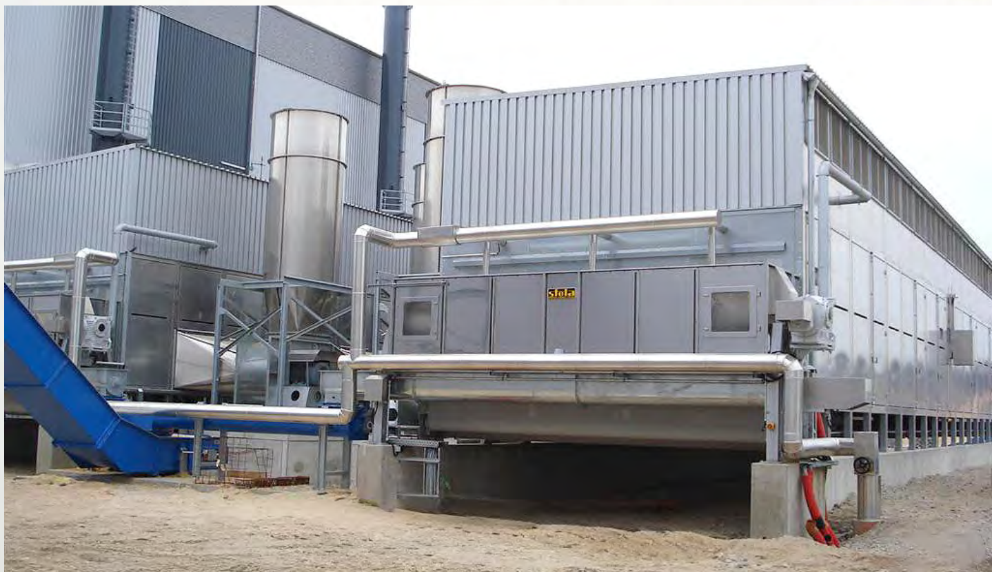
项目地：HIT Holzindustrie, 德国 | 型号：2x BT 1/6200-28.5 | 安装年份：2007 干燥物料：木屑 | 出料能力：约18.0吨/小时 | 降水区间：50% - 10% 湿度
