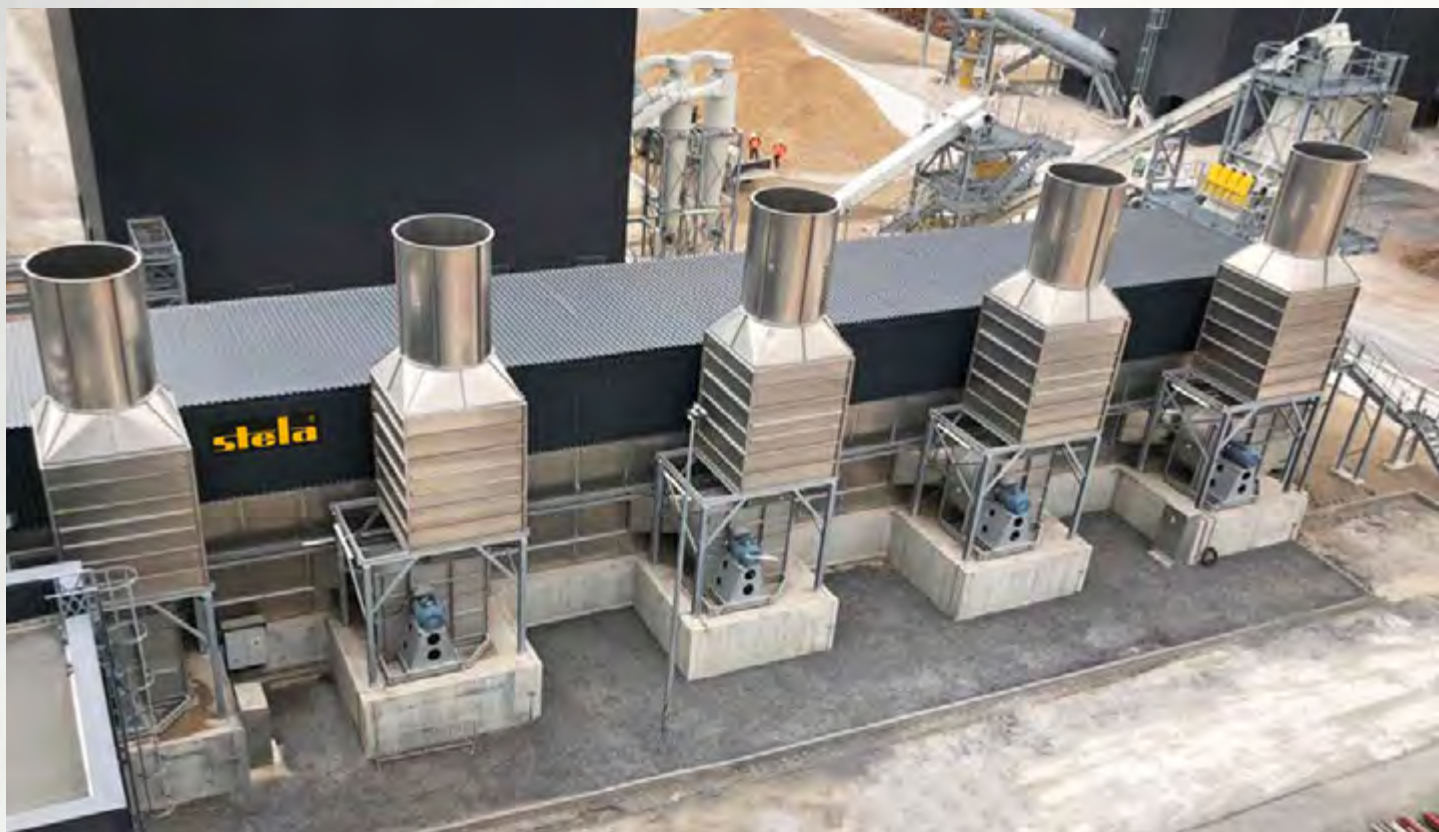
项目地：De Smet, FICAP, 法国 | 型号：BT 1/6200-42 | 安装年份：2019 干燥物料：木屑 | 出料能力：约17.0吨/小时 | 降水区间：50% - 10%湿度
