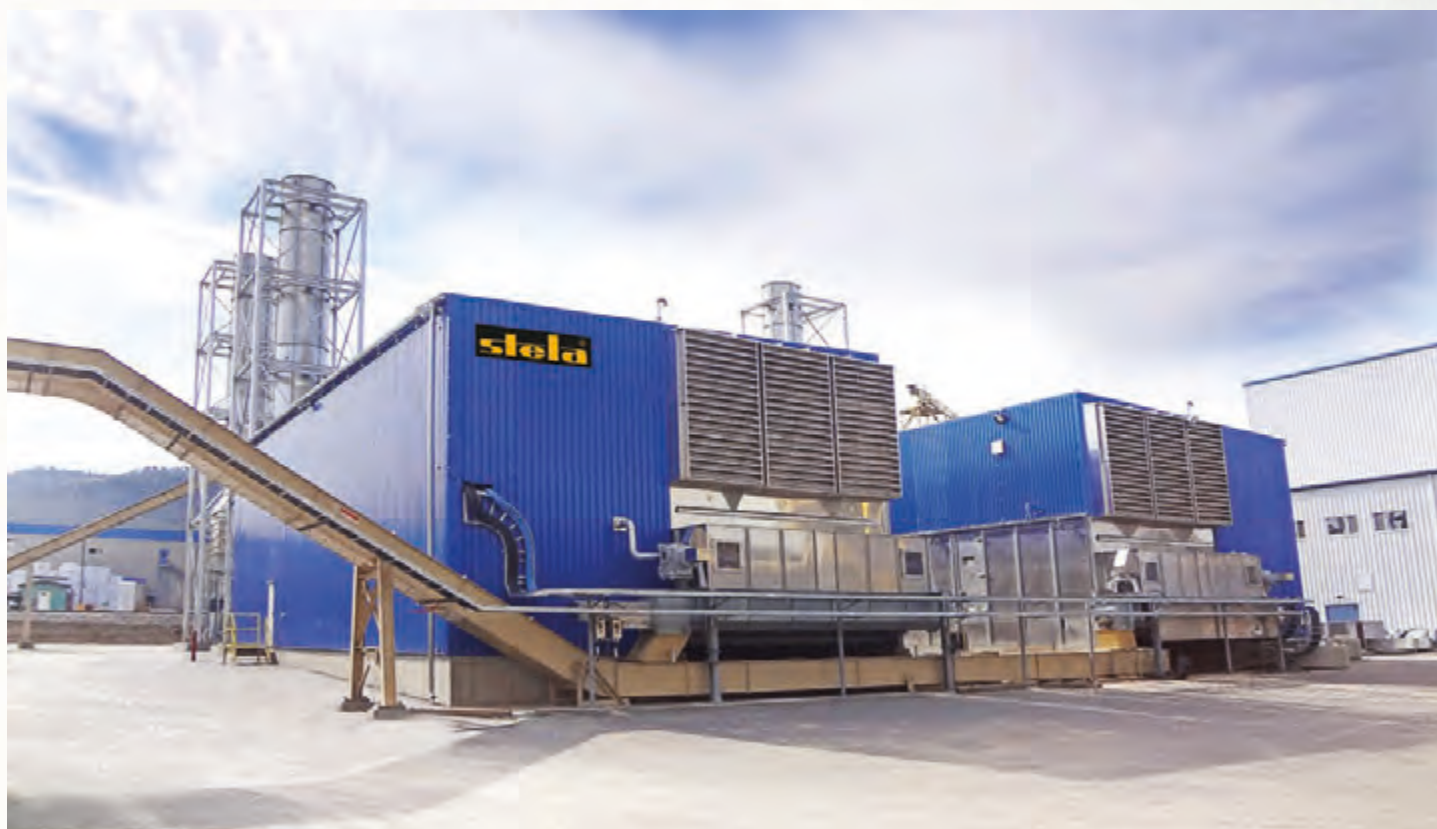
项目地：Pinnacle Renewable Energy Inc., 加拿大 | 型号：2x BT 1/6200-42 | 安装年份：2015 干燥物料：木屑 | 出料能力：约2x 13.0吨/小时 | 降水区间：50% - 6%湿度
