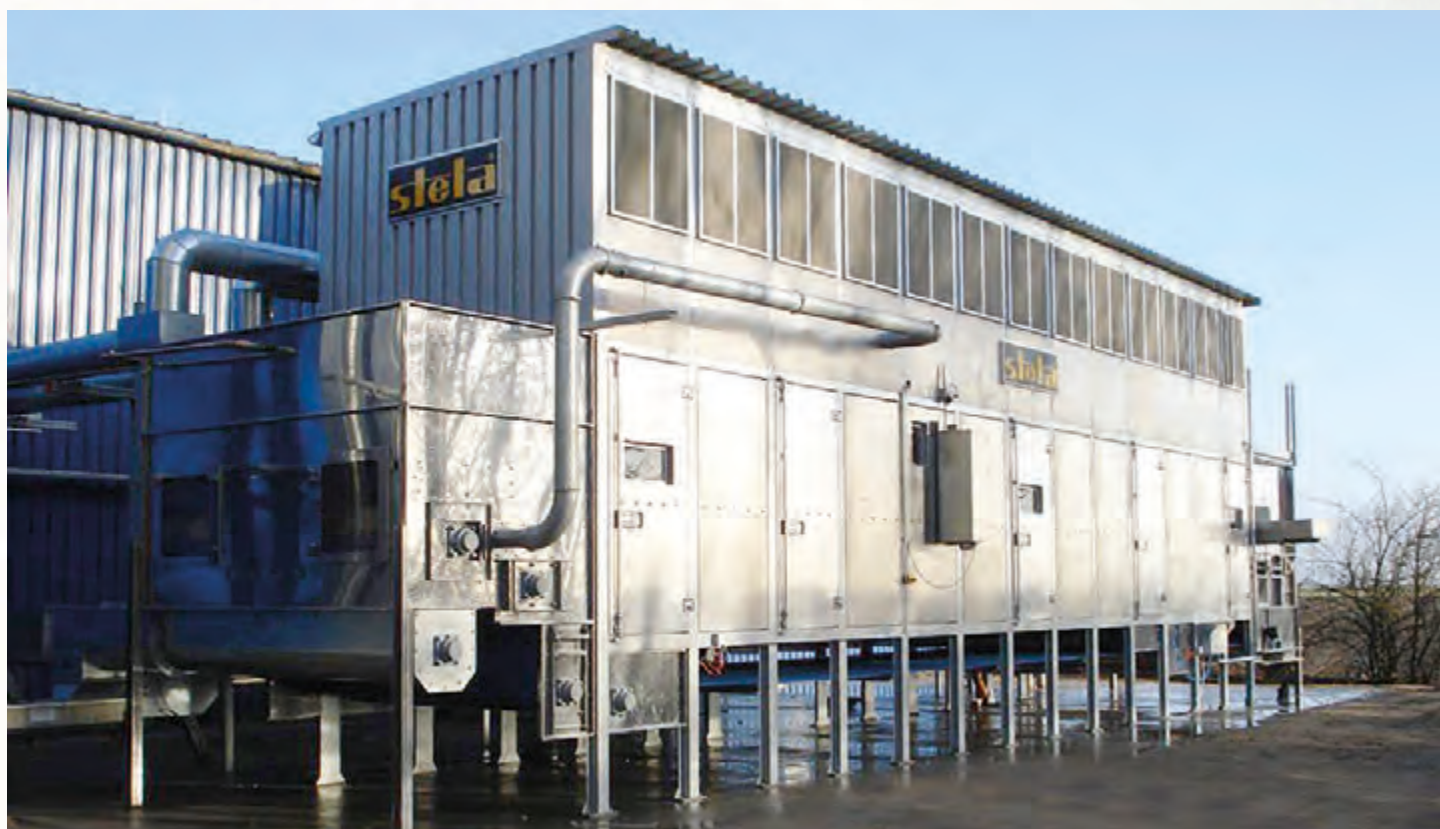
项目地：West Pellets, 德国 | 型号：BT 1/2700-13 | 安装年份：2008 干燥物料：木屑 | 出料能力：约1.6吨/小时 | 降水区间：50% - 10%湿度
