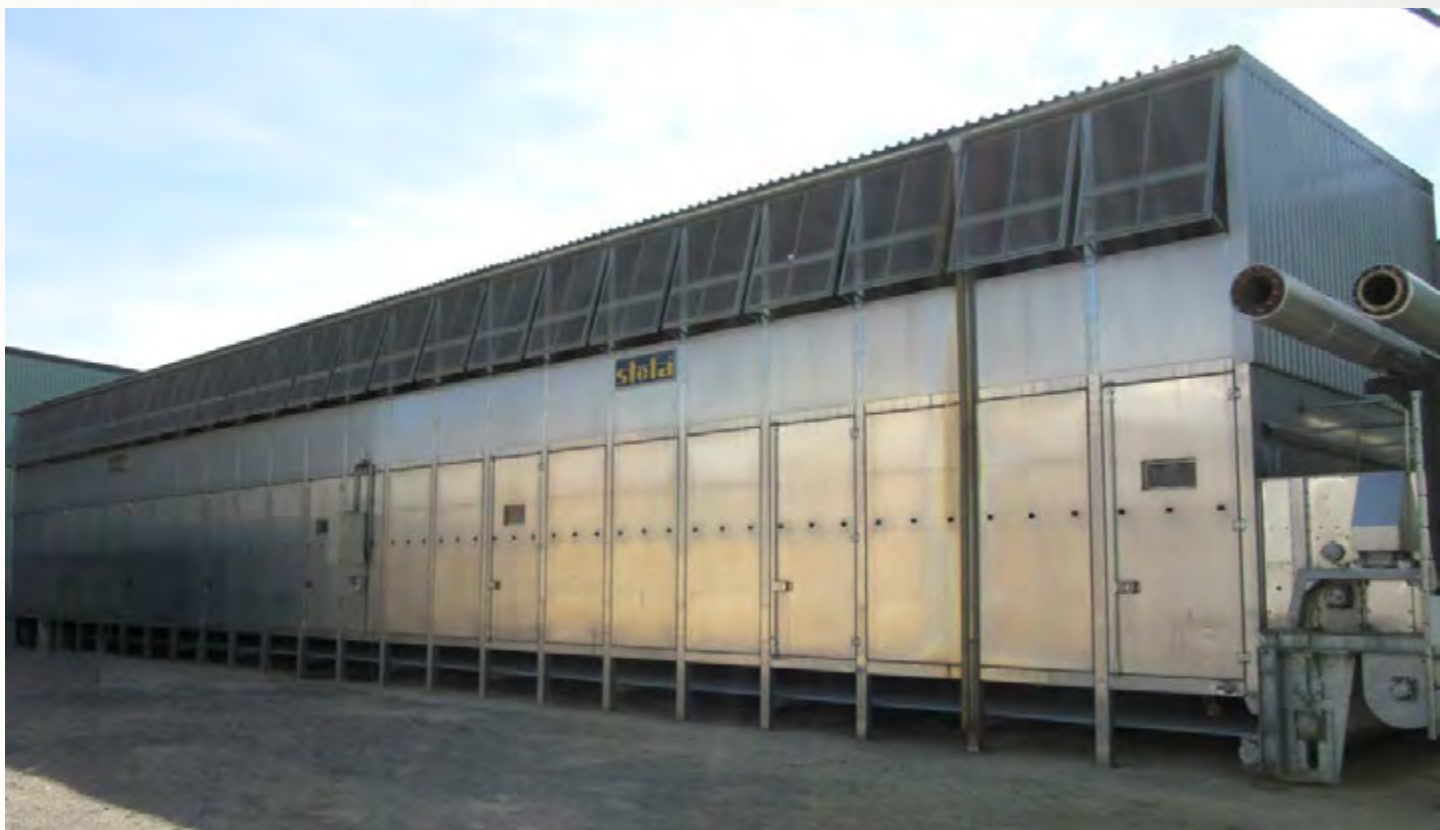
项目地：Stora Enso Timber, 瑞典 | 型号：BT 1/6200-36 | 安装年份：2008 干燥物料：木屑 | 出料能力：约10.0吨/小时 | 降水区间：52% - 10%湿度
