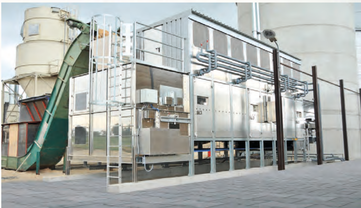
项目地：Ets Jung Albert, 法国 | 型号：BT 1/2700-8 | 安装年份：2011 干燥物料：木屑 | 出料能力：约1.2吨/小时 | 降水区间：50% - 10%湿度
