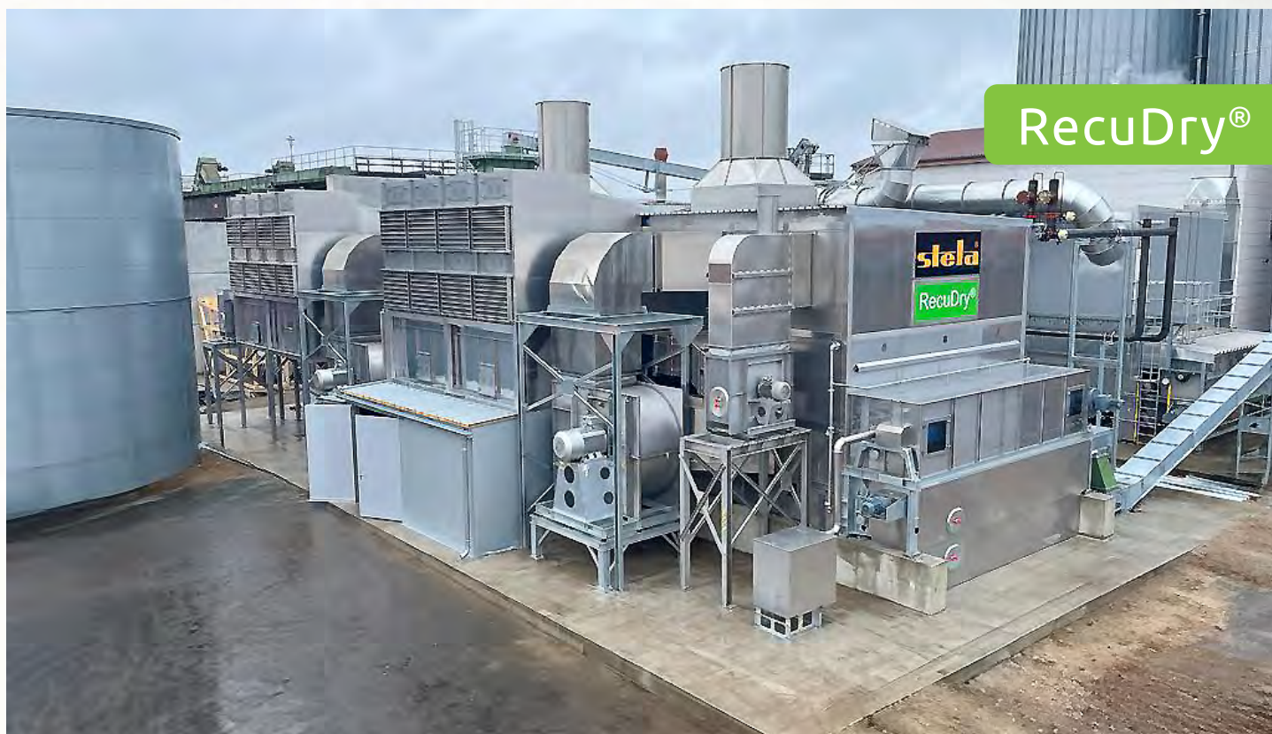
项目地：HMS-Holz GmbH, 德国 | 型号：BTU RecuDry 1/6200-24 | 安装年份：2023 干燥物料：木屑 | 出料能力：约7.0吨/小时 | 降水区间：50% - 10%湿度
