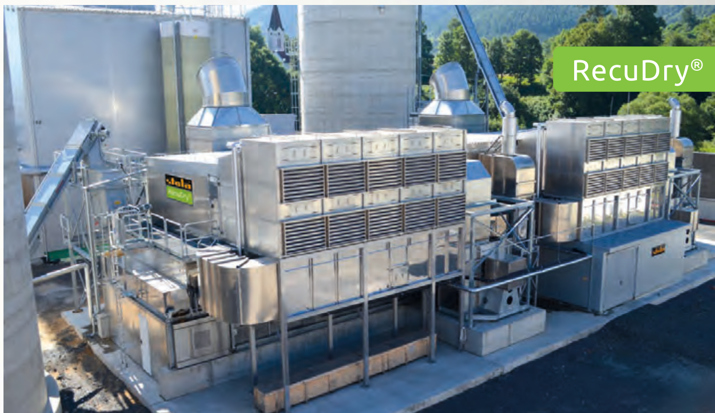
项目地：Rettenmaier Tatra Timber, 斯洛伐克 | 型号：BTU RecuDry 1/6200-30 | 安装年份：2019 干燥物料：木屑和湿磨木片 | 出料能力：约8.0吨/小时 | 降水区间：50% - 10%湿度
