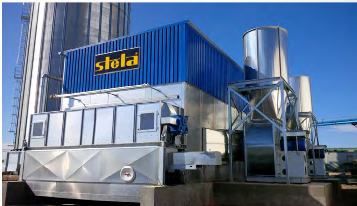
项目地：Del-Tech / Canfor, 加拿大 | 型号：BT 1/6200-16.5 | 安装年份：2015 干燥物料：木屑 | 出料能力：约11.2吨/小时 | 降水区间：37% - 8%湿度
