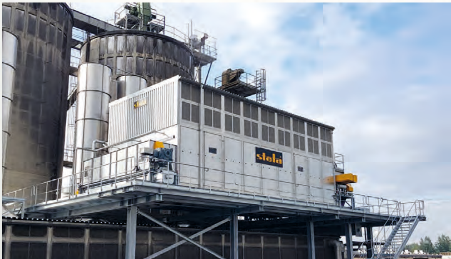
项目地: Mayr-Melnhof Paskov, 捷克 | 型号: BT 1/6200-13.5 | 安装年份: 2020 干燥物料: 木屑 | 出料能力: 约20.5吨/小时 | 降水区间: 50% - 45%湿度
