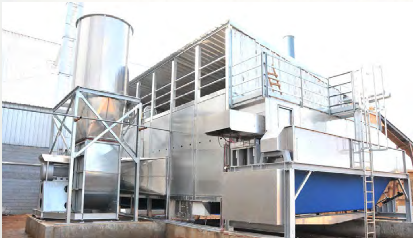
项目地：LARE S.A., 阿根廷 | 型号：BT 1/6200-9 | 安装年份：2013 干燥物料：木屑 | 出料能力：约2.95吨/小时 | 降水区间：50% - 11%湿度
